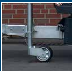
Roue d'appui robuste (proposée en option comme roue d'appui jumelée)
