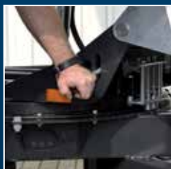
Couronne pivotante réglable, avec blocage à déblocage mécanique
